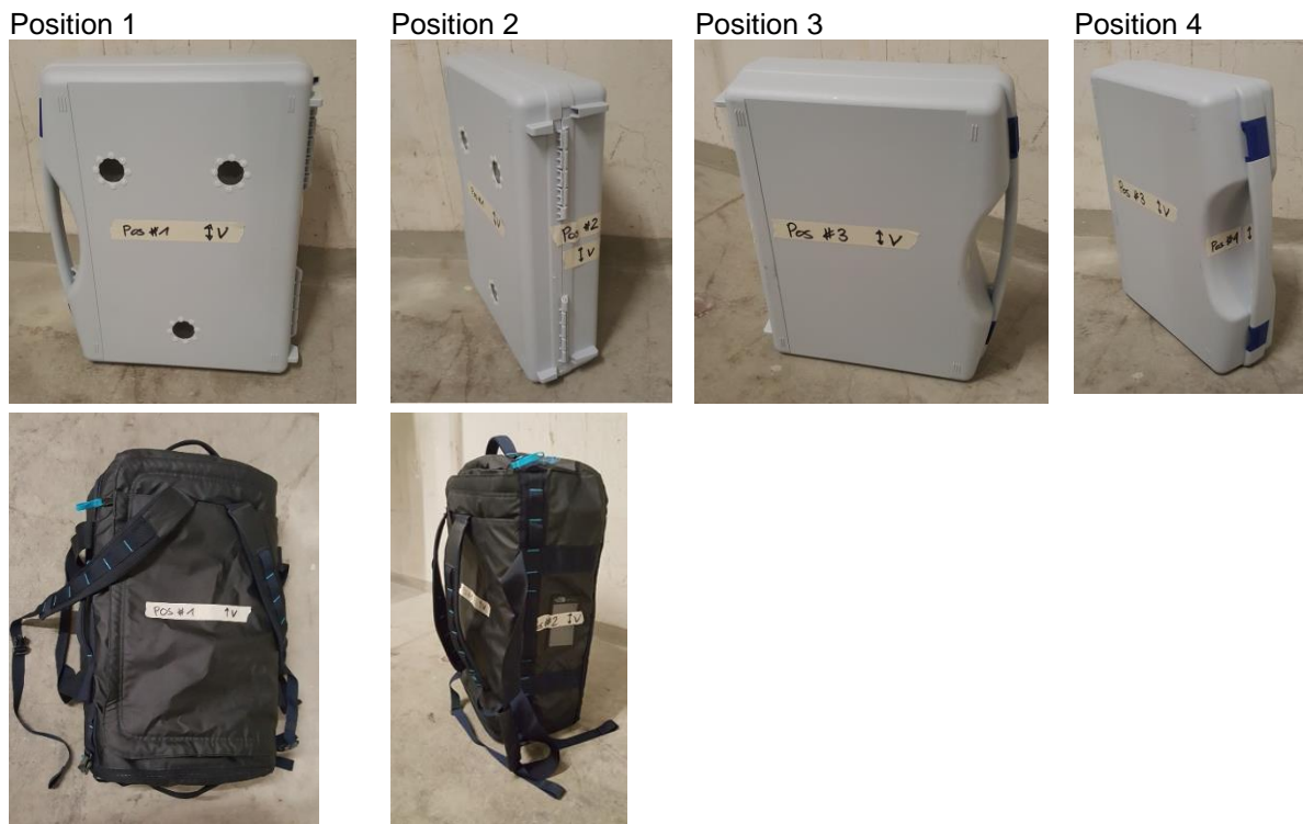
Figure 11: Désignations et orientation de la mallette de mesure et du sac à dos avec définition de la polarisation du champ incident
